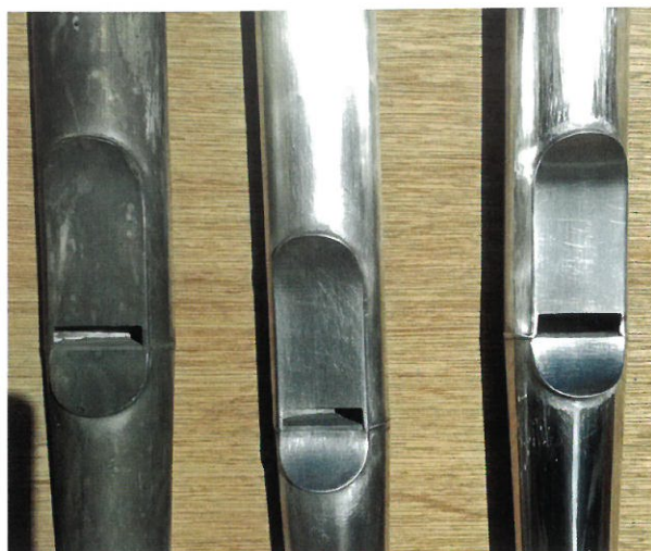
Frontpijp 1 na verwijdering verf, 2 na verwijderen oxidatielaag, 3 na polijsten
